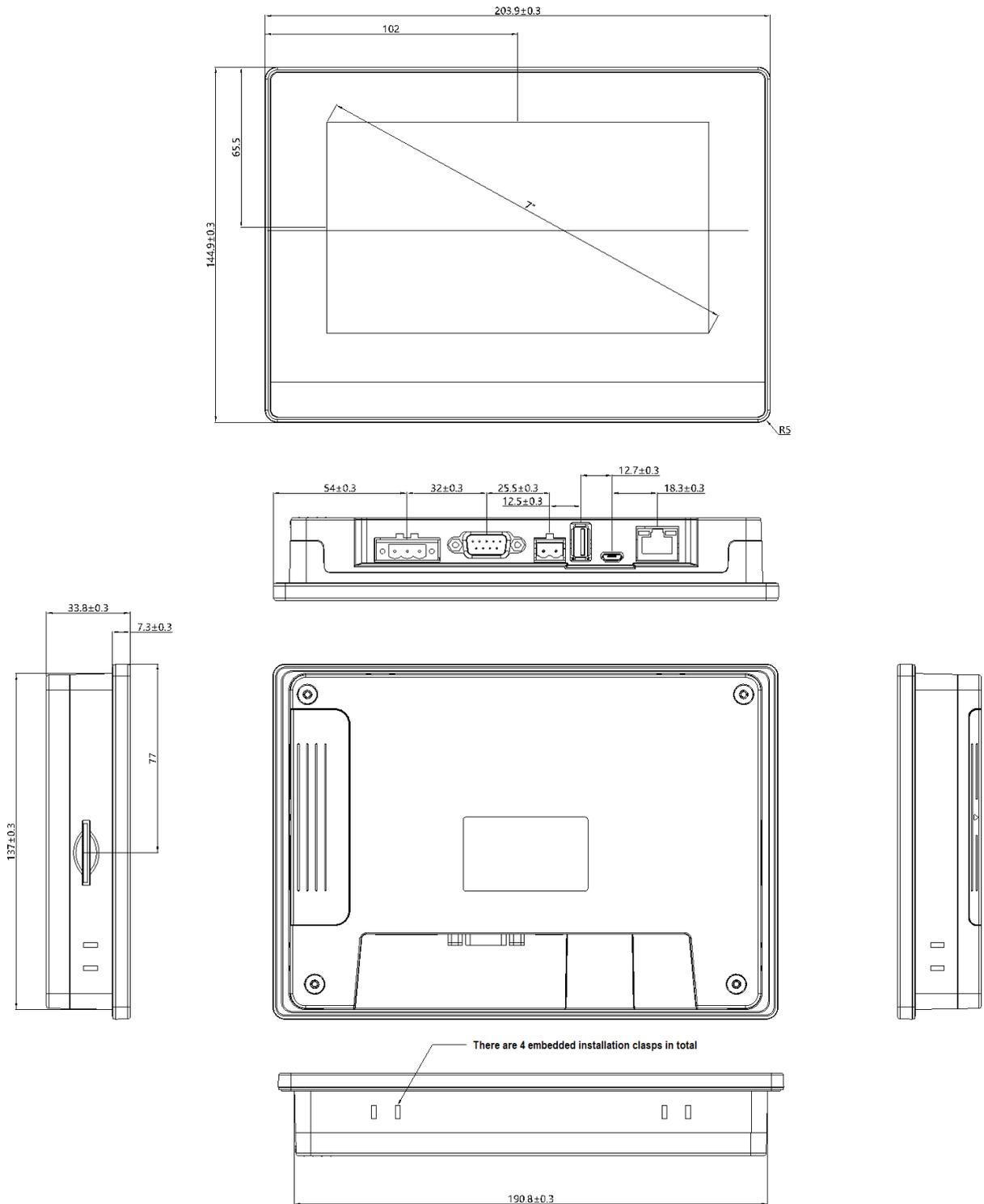
Размеры монтажного окна: 192 \* 138 (+ 1.5 мм / - 0.0 мм)
